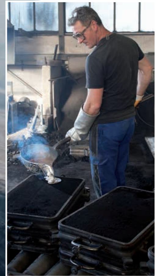
Hier ist es heiß: Salvatore Gambino befüllt gerade eine Form mit flüssigem Aluminium.
